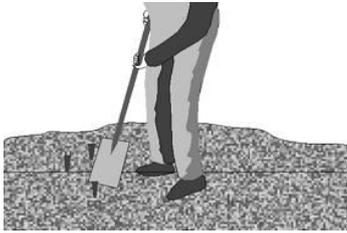
Entweder Löcher ausheben für Säulen mit Maßen 40 x 40 cm, oder nutzen Sie **besser einen Erdbohrer mit min. 20 cm Durchmesser**.
